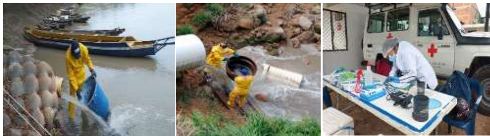
Imagen 29. Monitoreos compuestos vertimientos alcantarillado
